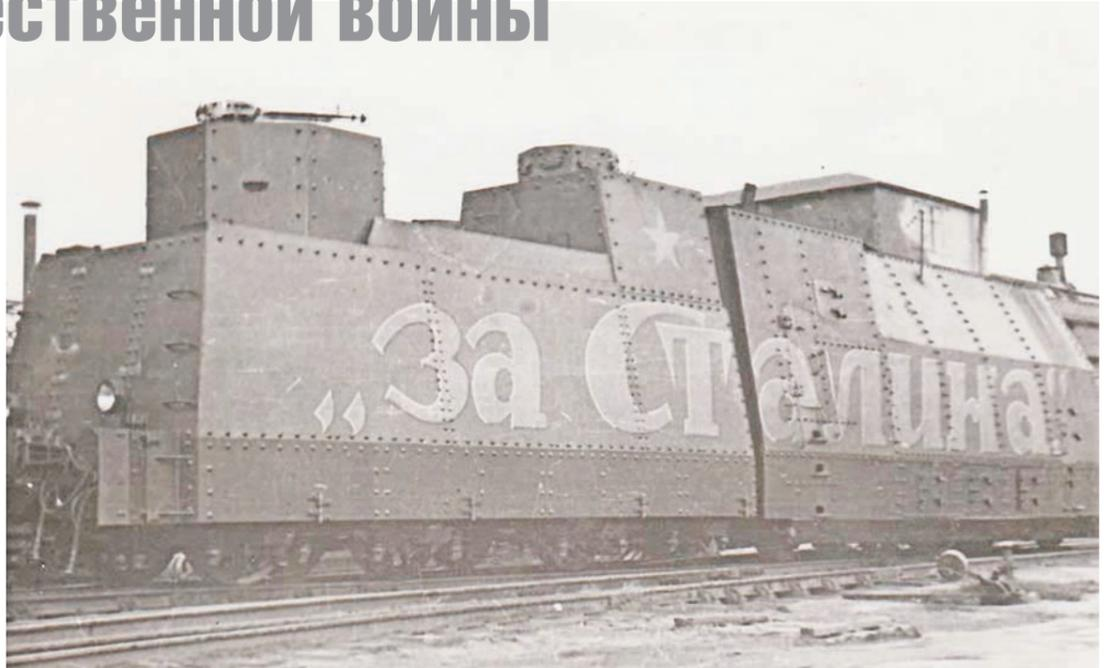
Одетый в броню паровоз 1-3-1 с тендером Особого бронепоезда № 1 «За Сталина».
