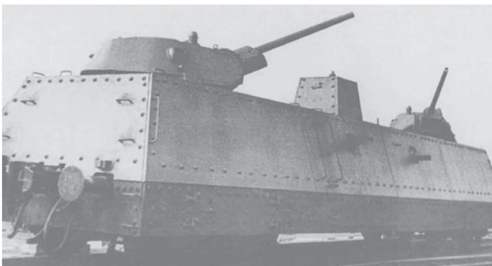
Артиллерийская бронеплощадка особого бронепоезда № 1 «За Сталина». На крыше установлены башни от танка Т-34, а по бокам по два пулемёта «Максима».
